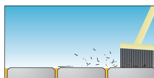
Lad opløsningen virke i 5-10 minutter. Belægningen fejes imens med en stiv kost. Undgå at udføre det i meget varmt vejr/direkte solskin.
