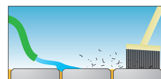
Til sidst fejes med en stiv kost samtidig med at der skylles efter med vand. Belægningen skal nu fremstå uden det hvide slør. Er det ikke tilfældet kan behandlingen gentages til det ønskede resultat opnås.
