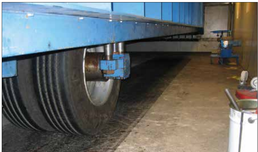
Figur 3.8. "Heavy vehicle simulator" som benyttes til test af belægninger. Midt i køretøjet er der monteret et hjul der kører frem og tilbage. Hjulet belastes, og der kan således hurtigt simulere mange lastbiler sammenlignet med den tid det ville tage hvis den "almindelige trafik" skulle benyttes.
