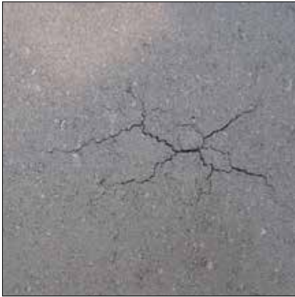
Figur 2.47. Til venstre ses revner i overfladen som følge af fejl i støbningen eller håndteringen. Til højre et eksempel på mangelfuld fyldning af formen, der har givet en fordybning i kanten af flisen. Sådanne fliser skal sorteres fra før lægningen.
