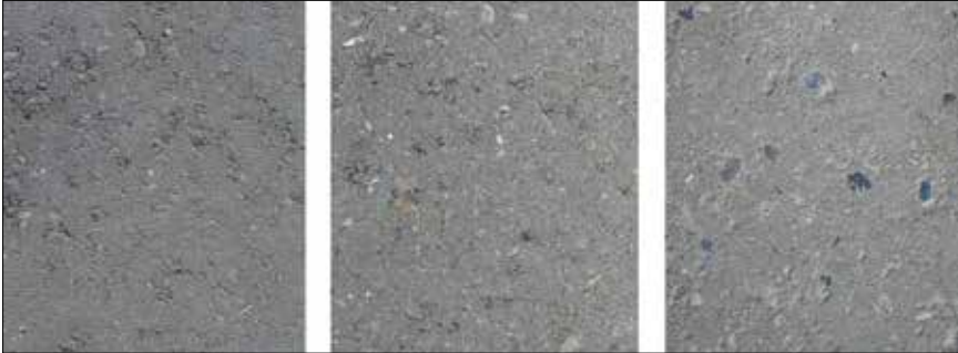
Figur 4.11. Ved afsyring af sten fjernes lidt af cementpastaen, så tilslaget bliver mere synligt, svarende til det slid der kommer i løbet af ca. ét år. Til venstre ses en ny sten, i midten en afsyret sten og til højre en ca. 1 år gammel sten.
