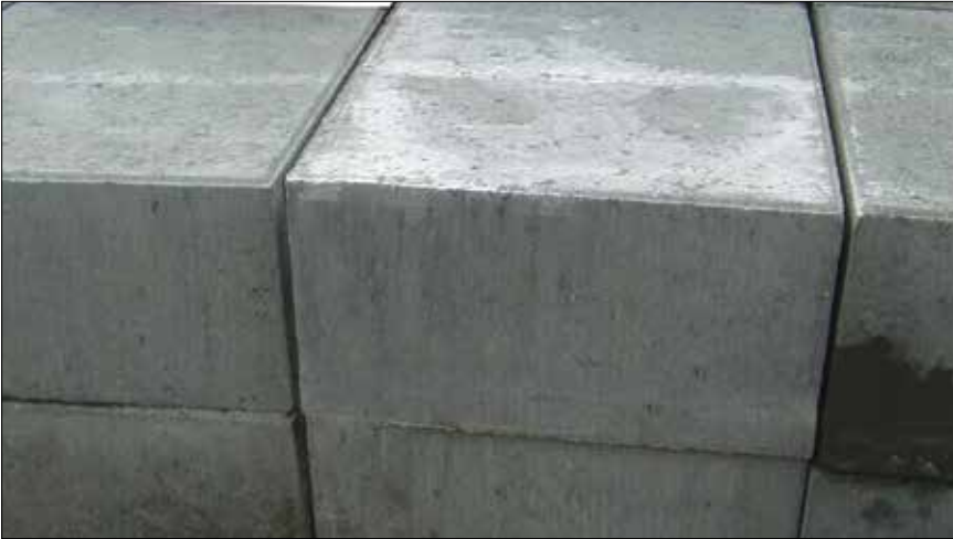
Figur 4.9. Kalkudfældninger opstår også ved oplagring på paller. Disse kalkudfældninger er almindelige og forsvinder som regel i løbet af 1-2 år.
