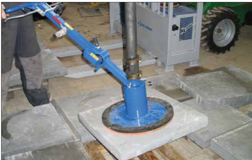
Figur 3.67. Før et maskinkøb bør der testes med en flise med 1 eller 2 stk. 6 mm huller i. Her en 50 x 50 x 5 cm flise med 2 stk. 6 mm huller.
