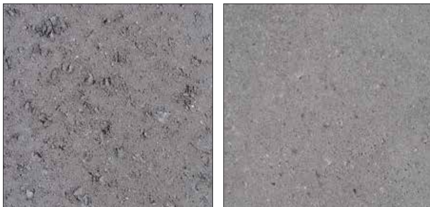
Figur 2.43. Til venstre ses en fliseoverflade med åben overflade og til højre en flise med en lukket overflade.
